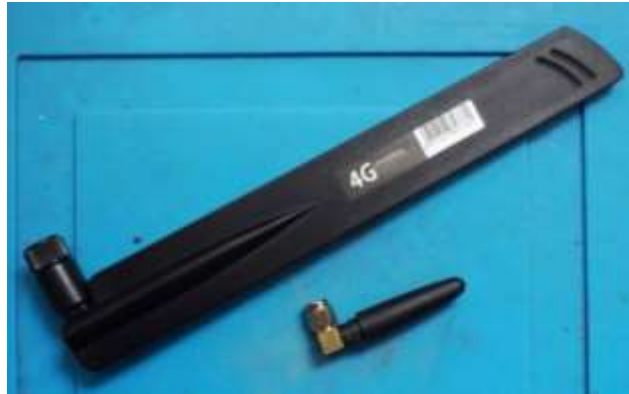
Şekil 2. Referans Ölçüm İçin Kullanılan Antenler
