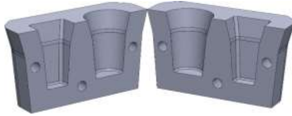
Şekil 2. Deneysel çalışmalar kapsamında kullanılan kokil kalıp
